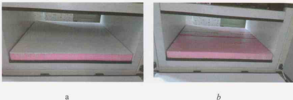
Rys. 3. Badanie w aparacie płytowym. Farba fotokatalityczna naniesiona na płytę z polistyrenu ekstrudowanego XPS a) od strony zimnej, b) od strony ciepłej
