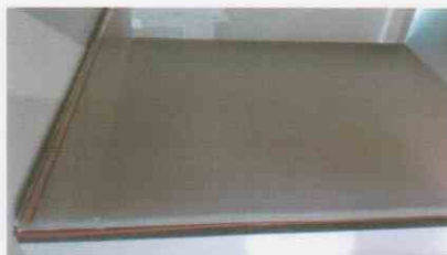
Rys. 1. Obiekt nr 39. Zespół szybowy z laminatem bez polimeru – obiekt referencyjny
