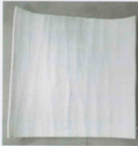
Rys. 1. Obiekt nr 1. Mata aerożelowa biała o grubości 13 mm
