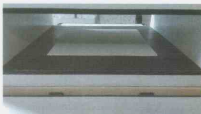
Rys. 1. Płyta z materiału termorefleksyjnego w aparacie płytowym
