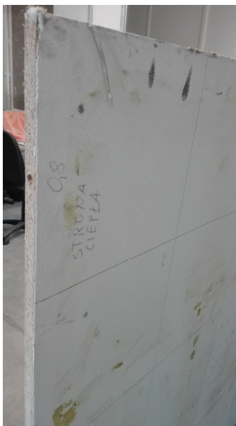
Rys. 5. Próbką z powłoką 1,7 mm od strony zimnej oraz 0,8 mm od strony ciepłej.
